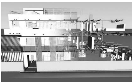
写真－3 施工前に問題点を検討するためのBIM
